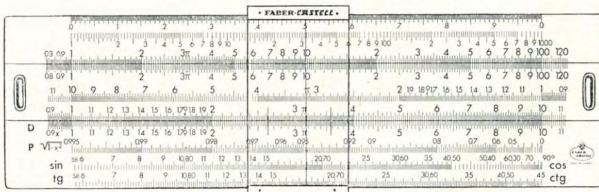
Abb. eines Demonstrations-Rechenstabes System Darmstadt
